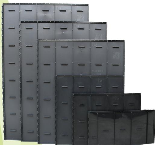
Les panneaux guide-racines **Green Route Protec®** répondent à toutes les exigences en matière de guidage racinaire. Ils sont spécialement dotés d'**arêtes verticales** qui empêchent le chignonage et guident sûrement et profondément les racines dans le sol. Pour éviter que les panneaux ne soient repoussés vers le haut ils sont aussi dotés d'**ergots horizontaux** qui empêchent les racines de remonter à la surface et maintiennent le panneau correctement positionné en terre.
